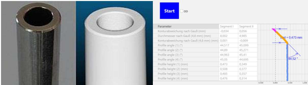
Şekil 5 Ölçüm Tablasına Yerleştirilmiş Hassas Boru Numunesi Ve Ağızdaki Pahların Kontrolü
