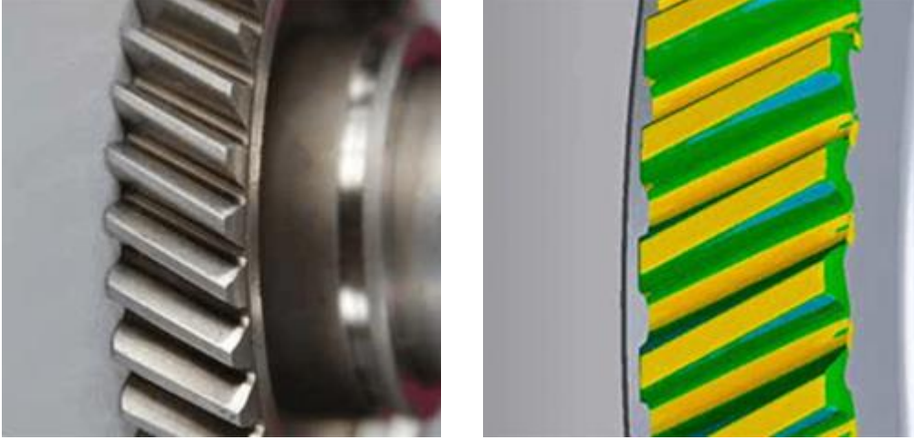
Şekil 1 Ölçülen Dişli Parça Ve 3D Tarama Çıktısının CAD Cizimi İle Otomatik Karşılaştırılması
